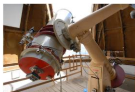
Le télescope de 62 cm de diamètre dans sa coupole
