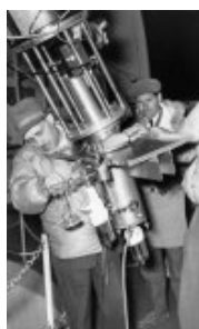
André Lallemand (avec chapeau) réglant la caméra électronique sur le télescope 120 cm de l'OHP © Photothèque OHP/CNRS
