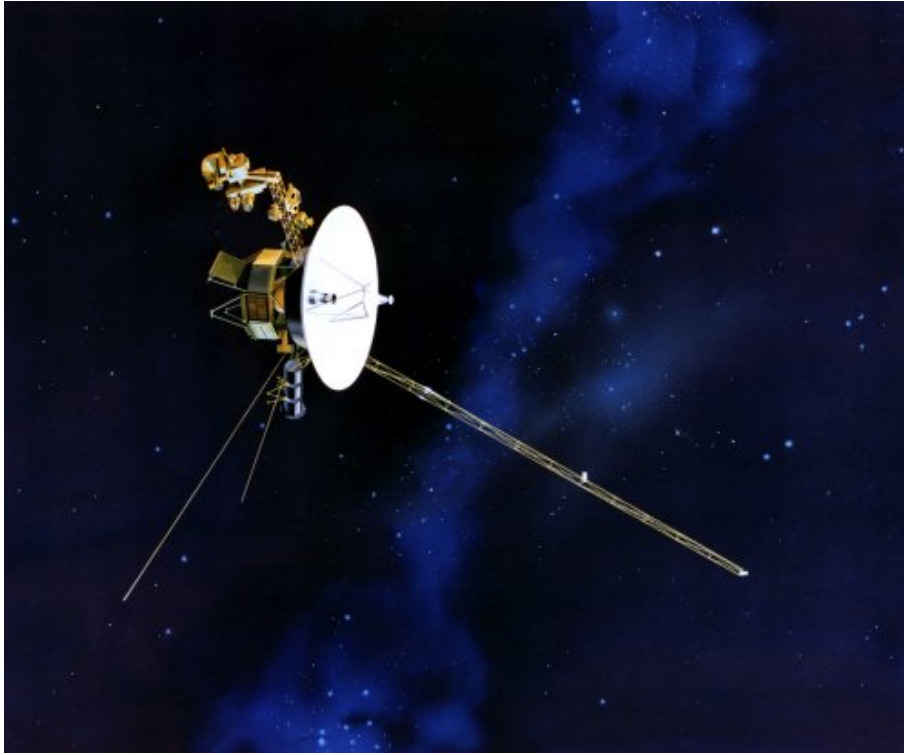
Représentation de la sonde Voyager 2, l'antenne à haut gain (en blanc) renvoie les données obtenues vers la Terre. © NASA
