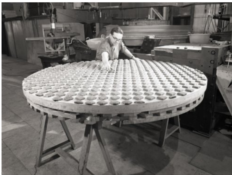
Outil sur pieds destiné à polir le miroir de 193 cm Jean Texereau contrôlant les plaquettes de résine collées sur l'outil de taille © J. Counil/Observatoire de Paris
