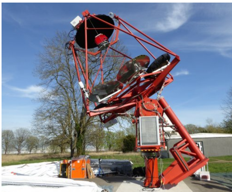
Le pGCT, prototype de télescope GCT proposé pour CTA, installé sur le site de Meudon
